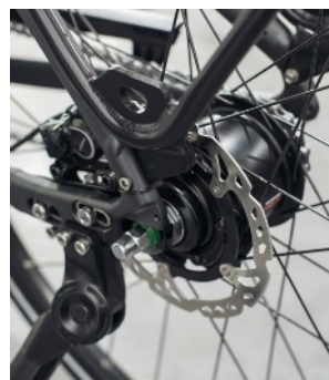
Le système à vitesses dans le moyeu est pratique et fiable.
