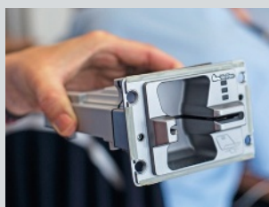
Un lecteur invisible a pu être installé dans un automate pour dupliquer votre CB (skimming).
