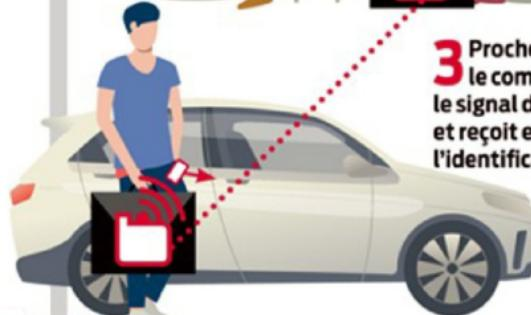
**# Les systèmes les plus anciens** Le conducteur doit poser sa main sur la poignée de porte afin qu'un capteur détecte sa présence et « prévienne » le calculateur ad hoc. Ce dernier envoie alors une requête au badge que le propriétaire de la voiture a sur lui afin de l'identifier. S'il y a concordance, celle-ci s'ouvre.
